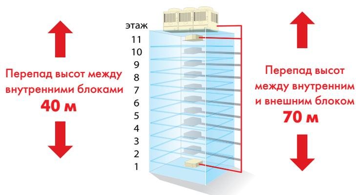
SMMS-i опережает конкурентов по максимально допустимому перепаду высот между внутренними блоками. Он может достигать 40 метров! Одна VRF-система Toshiba SMMS-i способна полностью кондиционировать 11-этажное здание.
